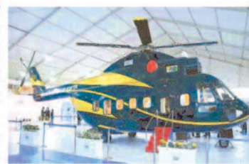
एमआई-8 हेलीकॉप्टरों की जगह लेगा। आईएमआरएच का वजन 13 टन होगा। यह भारतीय सशस्त्र बलों के साथ हवाई हमले, पनडुब्बी रोधी, जहाज-रोधी, सैन्य परिवहन और वीवीआईपी की भूमिका में होगा।
